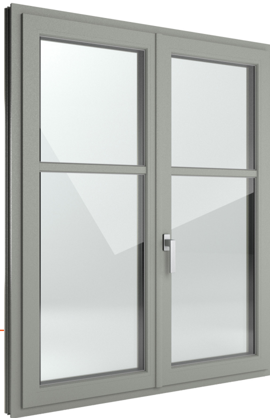
Abbildung in zweiflügliger Ausführung mit Glasleiste und aufgesetzter Sprosse im Design Classic, außen Aluminium Leichtbronze LC31 und innen Kunststoff Grau 06
