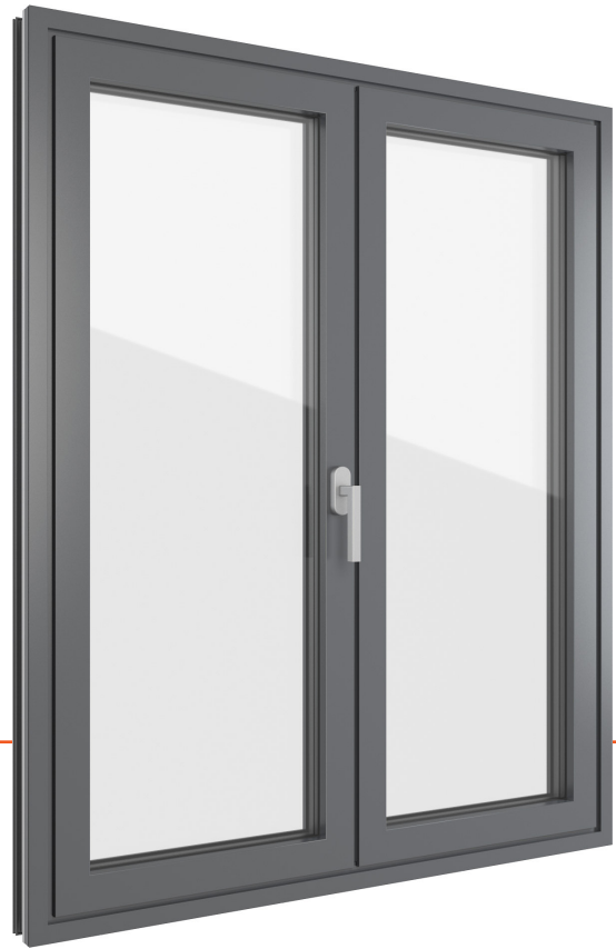
Abbildung in zweiflügliger Ausführung mit raumseitig flächenbündigem Blendrahmen und Flügel, außen und innen Aluminium Sablé 893 Anthrazitgrau
